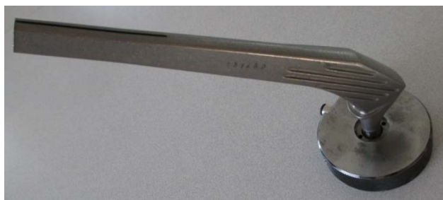
Figure 3 – Gicleur pour mesure du plan de jauge d'une tige fémorale
