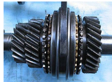
Figure 2 – Engrenages d'une boîte de vitesse sur leur arbre (source: Wikipedia)
