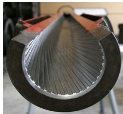
Figure 1 – Structure interne d'un canon rayé (Source: Wikipedia)
